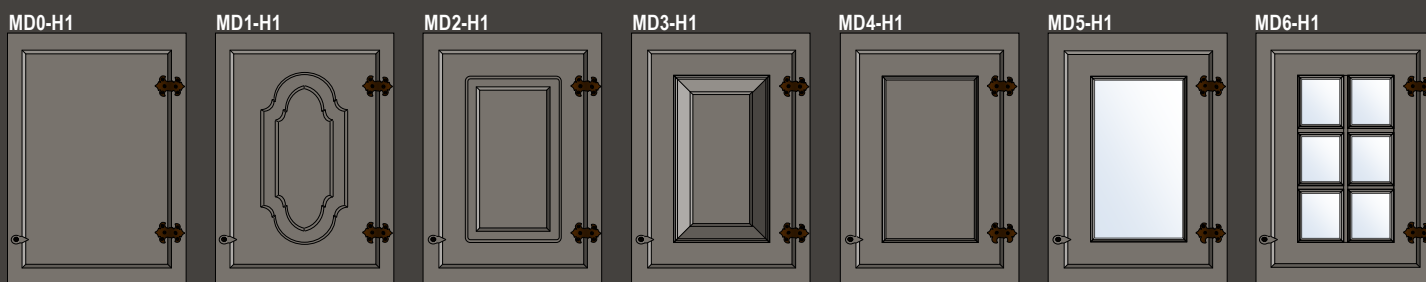
Hengsle H1 Rustikk (std). Døren falses, 14 mm synlig utenpå skapfront. Hengsle kombinert med den eldre tradisjonsrike trevrideren gir et rustikk bonderomantisk uttrykk. - Rustikk hengsle H1 og trevrider er inkl i pris.
